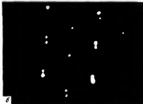
Рис. 5.23. Схема ступенчатой поверхности платины [9 (111) × (111)] (а) и ее дифракционная картина (б)
