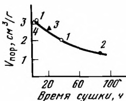
Рис. 9.9. Влияние скорости сушки на общую пористость Режим сушки: 1 — 290 К, ток сухого воздуха; 2 — 290 К, ток влажного воздуха; 3 — 290 К, вакуум; 4 — 420 К, сушильный шкаф
